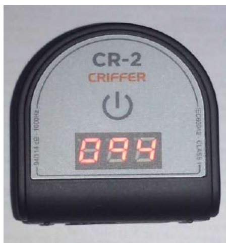
Figura 5 – Calibrador Acústico utilizado nesse trabalho para os procedimentos de verificação do Medidor de Nível de Pressão Sonora. Fonte: elaborado pelo autor (2018).
